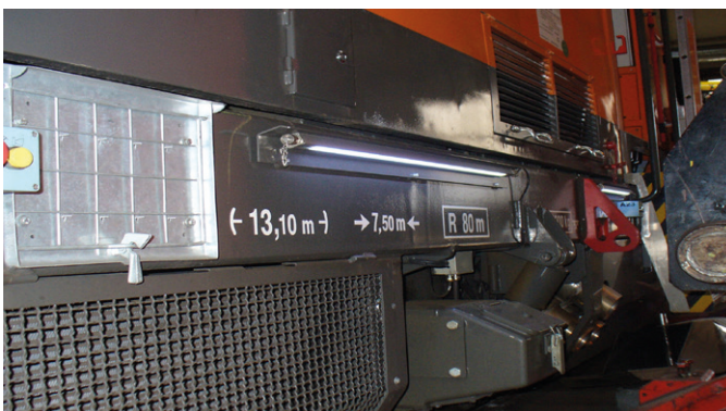
Randwegs- und Sicherheitsbeleuchtung Gleisbaumaschine
