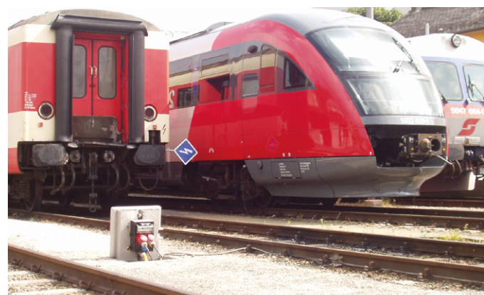
Referenzprojekt: In Linz-Urfahr / Österreich wurde der GIFAS PIAZZA 540 für die Zuganspeisung eingebaut. Wegen des geringen Abstandes zwischen den Gleisen, hat man sich für ein Unterflurenergiesystem entschieden.
