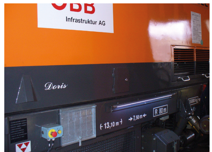
Randwegs- und Sicherheitsbeleuchtung Gleisbaumaschine
