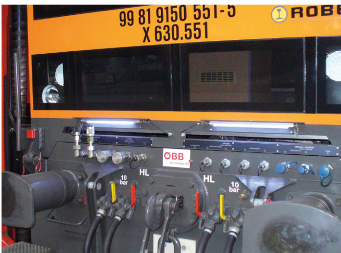
Randwegs- und Sicherheitsbeleuchtung Gleisbaumaschine
