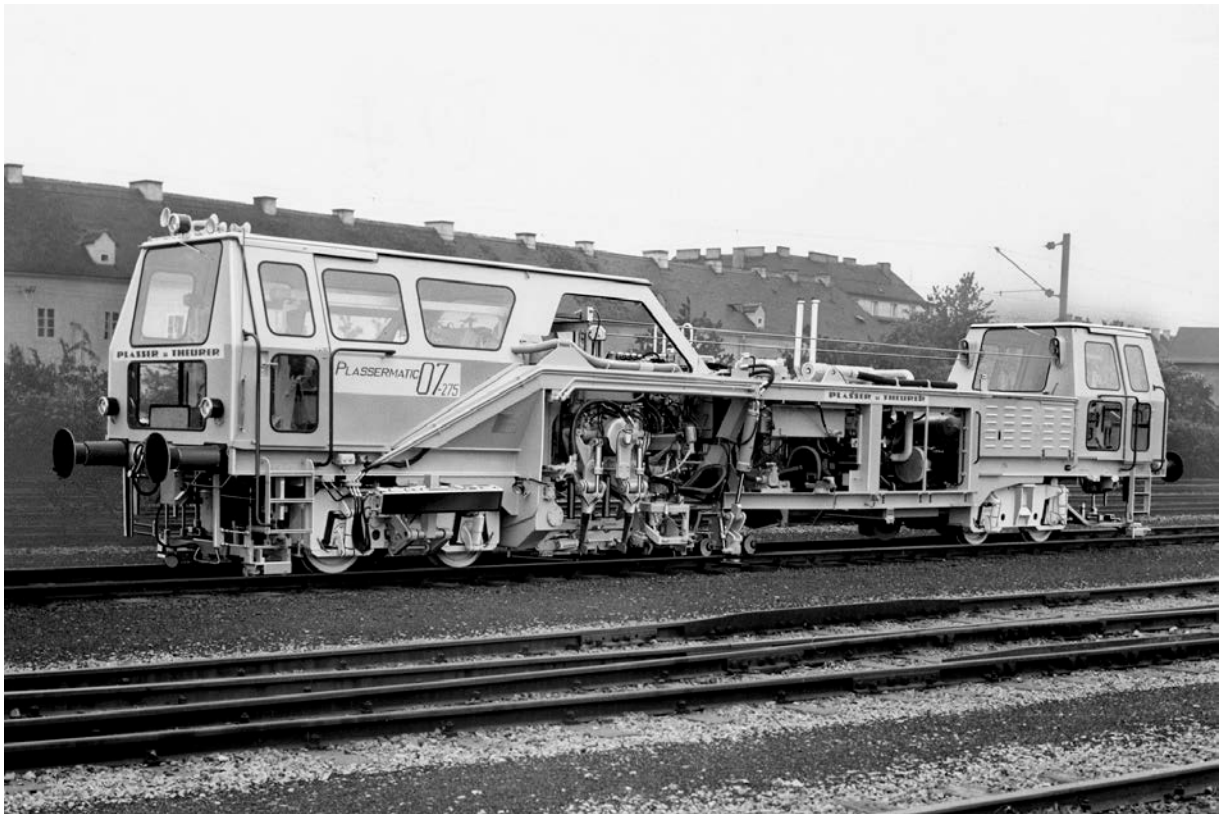
Erste Stopmaschinenreihe in Regelfahrzeugbauweise 07-Serie Foto: Plasser & Theurer
