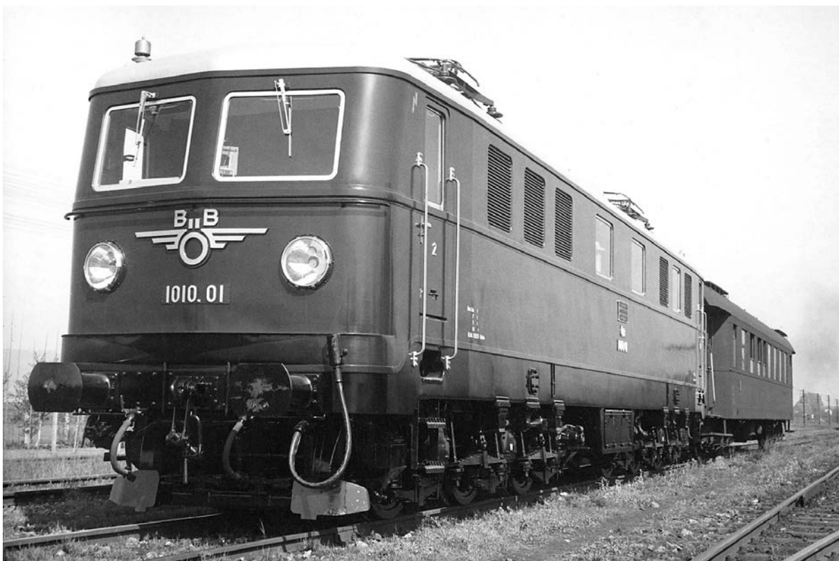
ÖBB sechsachsige Schnellzuglokomotive 1010.01, Baujahr 1955 Foto: Brown Boveri / Archiv BAHNINDUSTRIE.at
