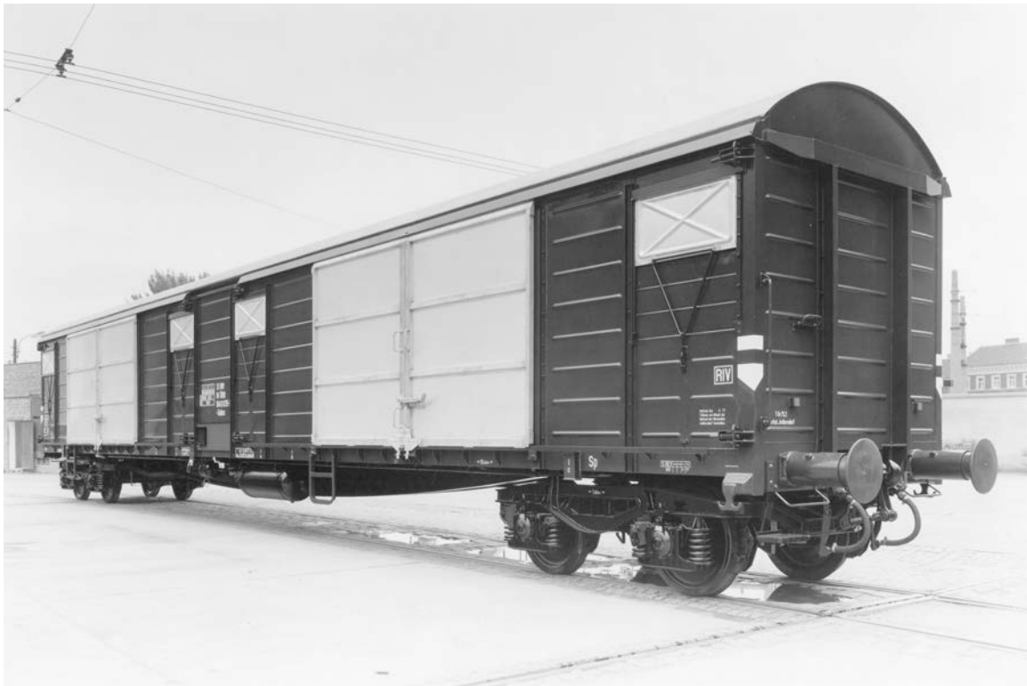
ÖBB vierachsiger Großraumgüterwagen Gabss, Baujahr 1973 Foto: Archiv Siemens
