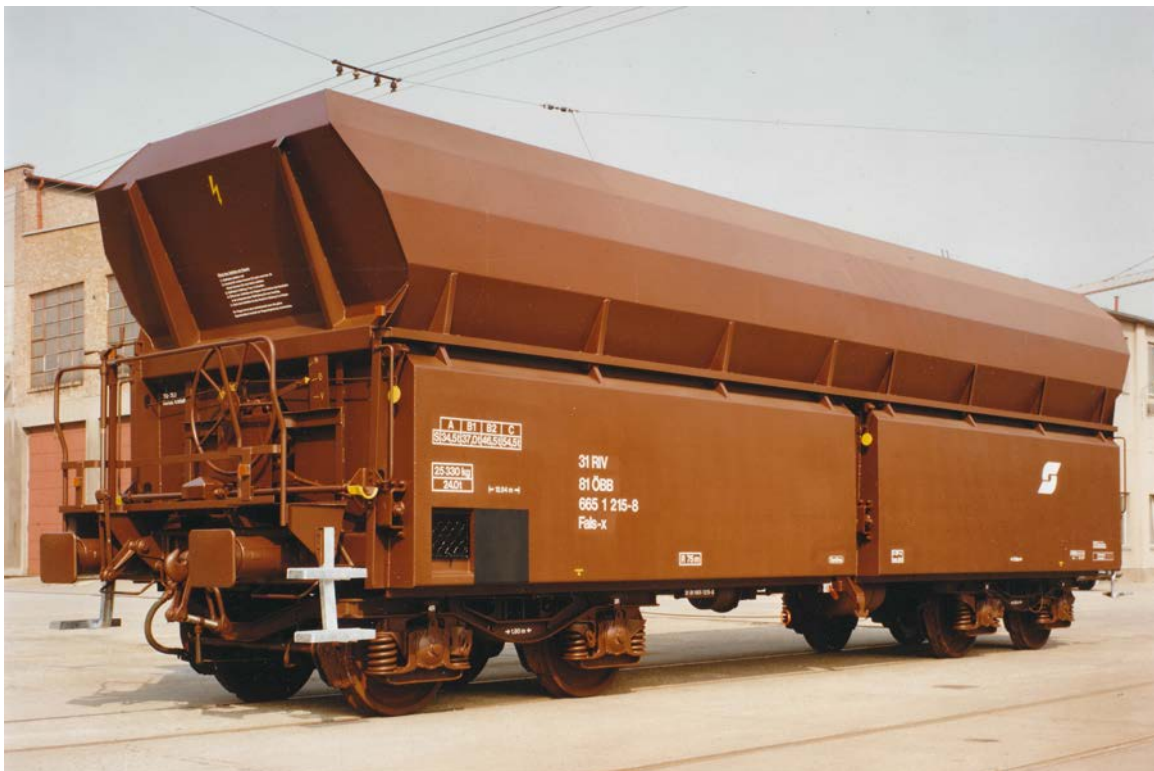
ÖBB vierachsiger Schüttgutwagen Fals-x, Baujahr 1983 Foto: Archiv Siemens
