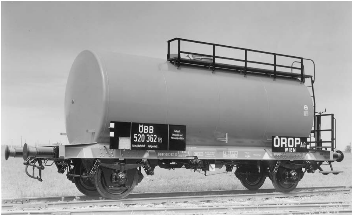
ÖBB 520 362, zweiachsiger Kesselwagen (Raxwerke), ÖROP A.G. WIEN, 360 hl, Baujahr 1961 Foto: Archiv Siemens
