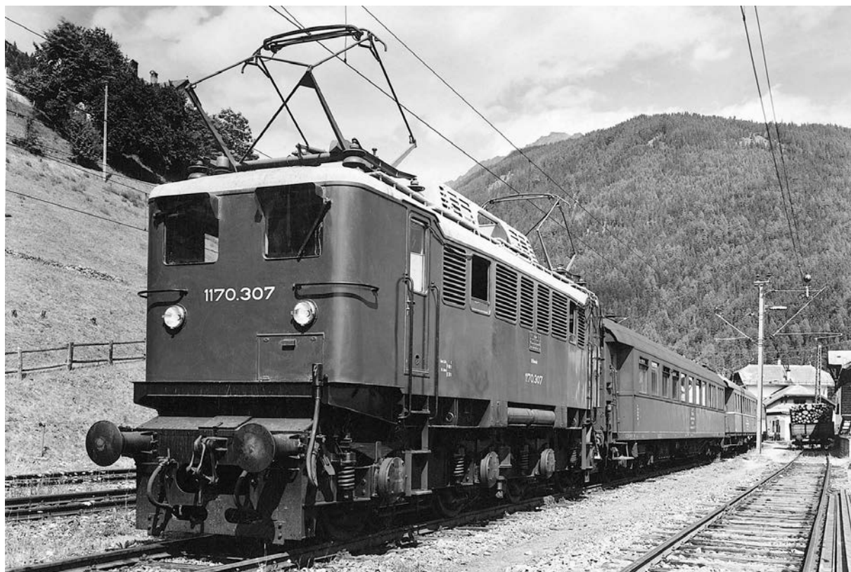
ÖBB Elektrolokomotive 1170.307 (Baujahr 1951, spätere Baureihe 1040) mit Messwagen auf der Tauernbahn in Obervellach
