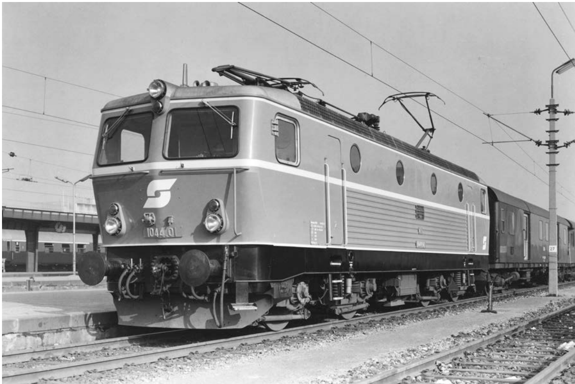
ÖBB vierachsige Thyristorlokomotive 1044.01, Baujahr 1974 Foto: Archiv Siemens
